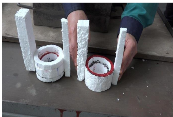
Fig.3. Canale de turnare și aerisiri
