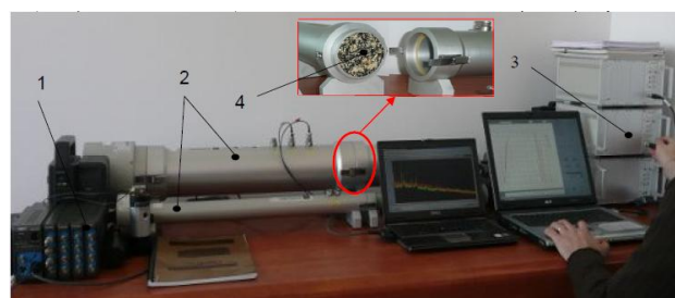
Fig.6. Instalatia pentru analiza probelor:1- Generator zgomot alb si sistem achizitie, 2-Tub de impedanta, 3-Amplificator de semnal, 4-Proba.
