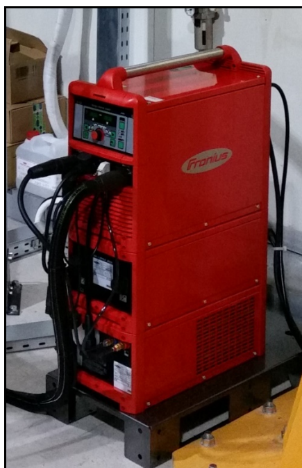
Fig. 3. Sursă de sudare digitală TIG – FRONIUS MagicWave 2500 Job G/F
