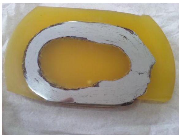
Fig. 2. Za de lanț debitată longitudinal și înglobată în rasina fenolică.
