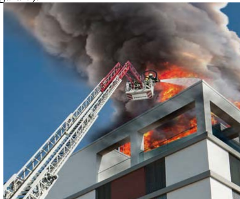
Fig. 7 – Autoscară folosită ca turn de apă (sursă de apă)
