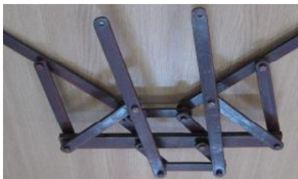
Fig.3. Mecanismul pentru pășire inventat de Cebîșev
