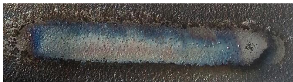
Fig. 18 Exemplu de cordon realizat în curent alternativ (proba 1.3a)
